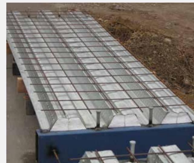
Espécimen con viga metálica y conectores de corte
