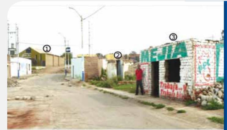
1. Iglesia de adobe sin daños. 2. Vivienda de albañilería dañada. 3. Vivienda que se hundió 0.40 m. Distancia entre 1 y 3 = 50 m. Claro efecto de microzona. Foto Dic. 2013.
