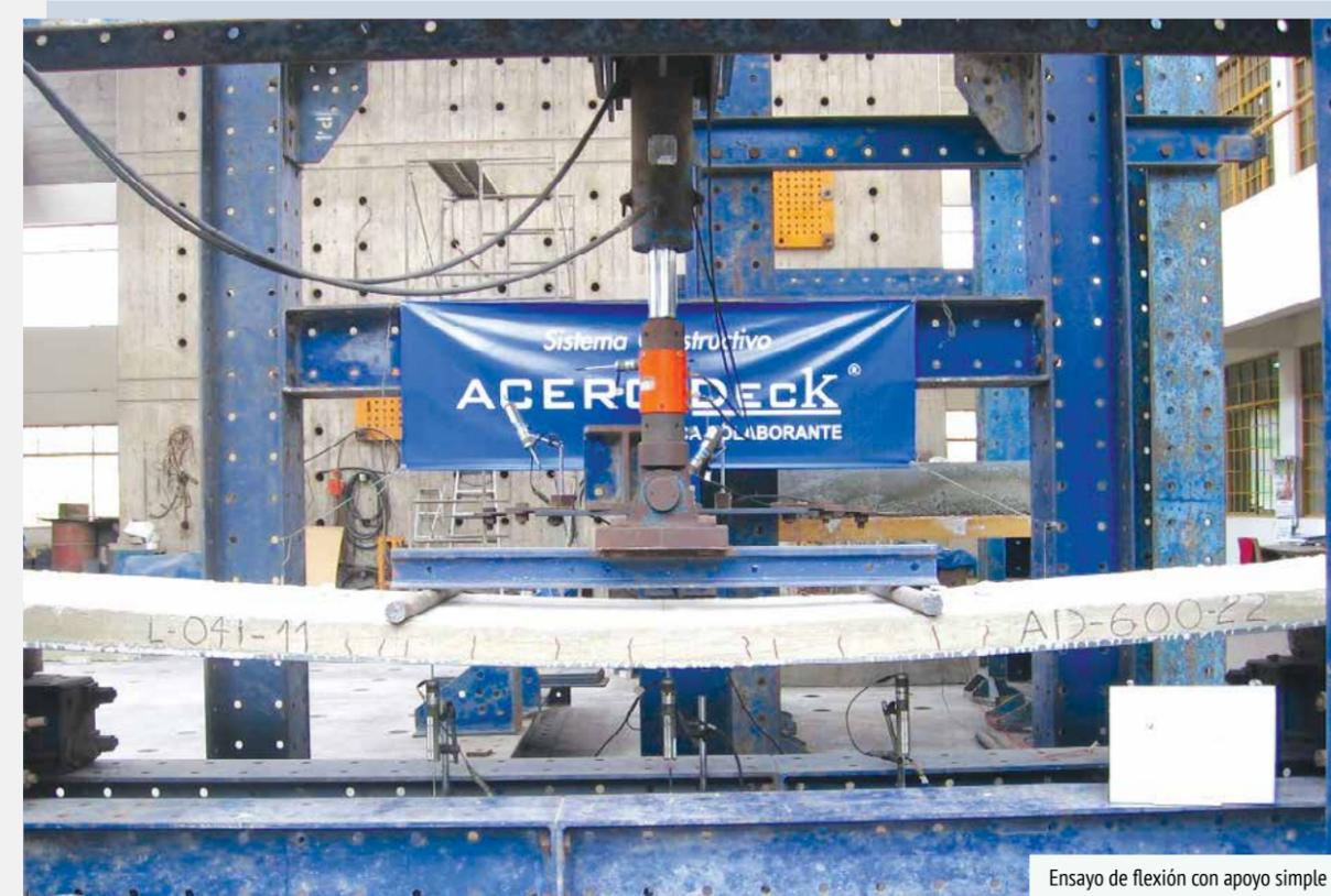
Ensayo de flexión con apoyo simple
