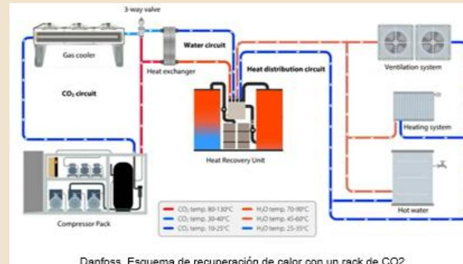
Danfoss. Esquema de recuperación de calor con un rack de CO2
