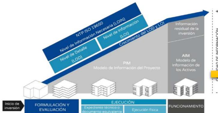
FIGURA 4 - PROGRESIVIDAD DEL NIVEL DE INFORMACIÓN SEGÚN LAS FASES DEL CICLO DE INVERSIÓN – Guía Nacional BIM
