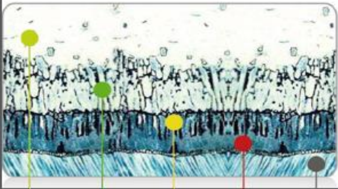
Micro estructura de un recubrimiento galvanizado en caliente
