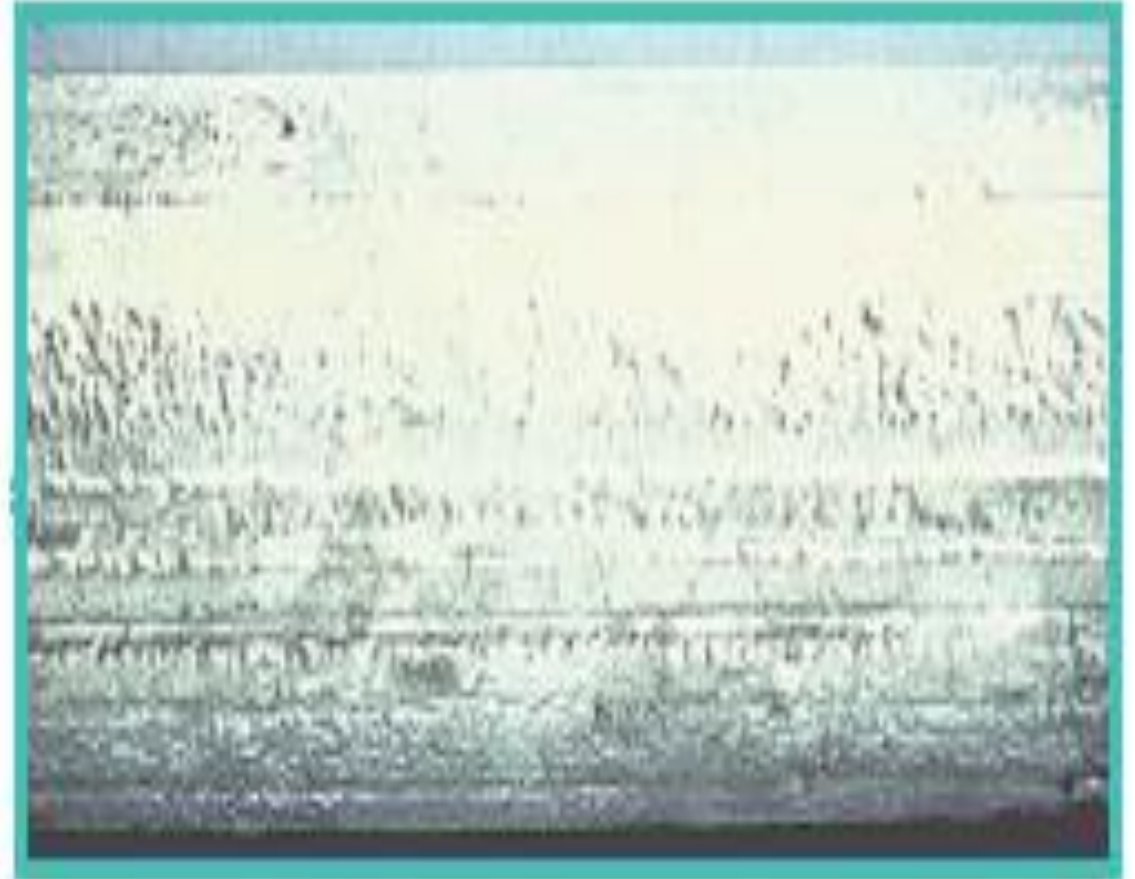
ILUSTRACIÓN REVESTIMIENTO ÁSPERO POR NIVELES DE FÓSFORO MAYORES AL 0,04% (ACEPTABLE MENOS EN BARANDA)
