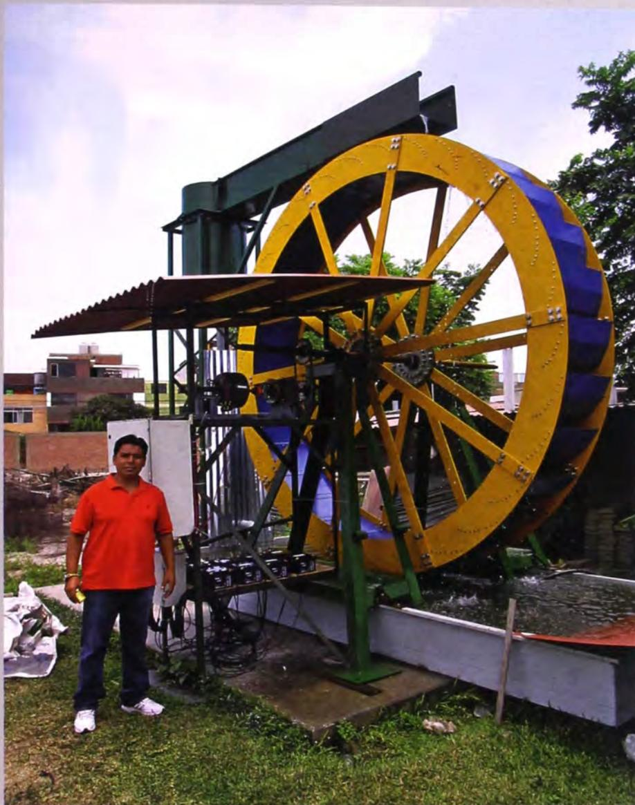
Rueda hidráulica con generador de imanes permanentes WAIRA 1kW.
