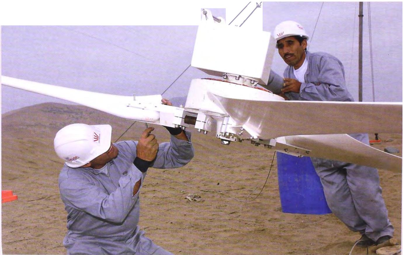
Montaje de aerogenerador W/AIRA 5.0 (3kW) durante pruebas de campo en Huacho.
