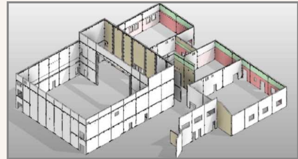
Figura 7: Ejemplo de Modelo 3D de paneles prefabricados en la plataforma BIM.
