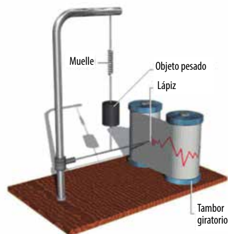
Esquema representativo del funcionamiento de un sismógrafo
