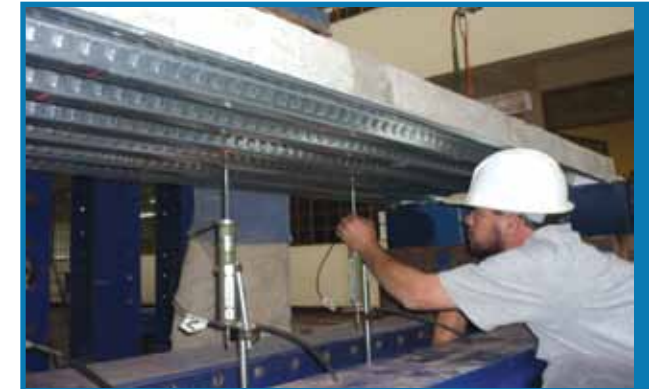
Ensayos Flexión en CISMID a la placa colaborante Acero-Deck®
