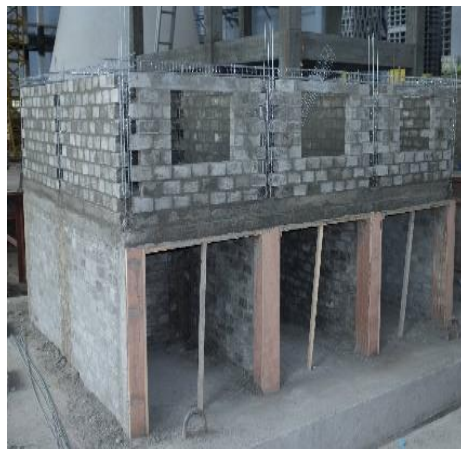
倒塌机理研究模型制作过程
