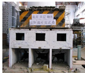
PGA0.8g输入后, 模型内伤严重, 成为“站立废墟”
