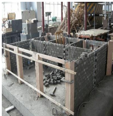
倒塌机理研究模型制作过程
