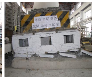
PGA1.0g输入后, 模型沿其纵向倒塌
