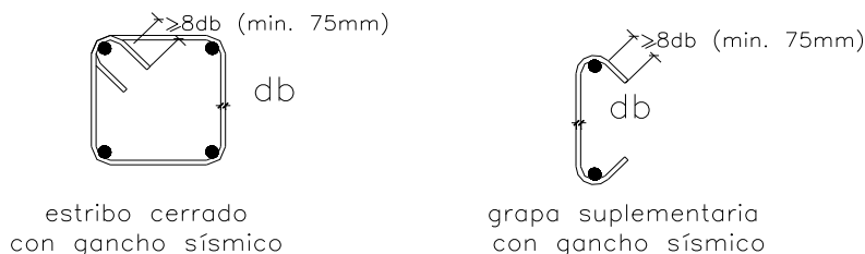
Fig. 21.1d Ganchos sísmicos en estribos y grapas suplementarias
