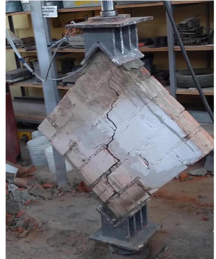
Patrón de falla de los muretes expuestos al fuego
