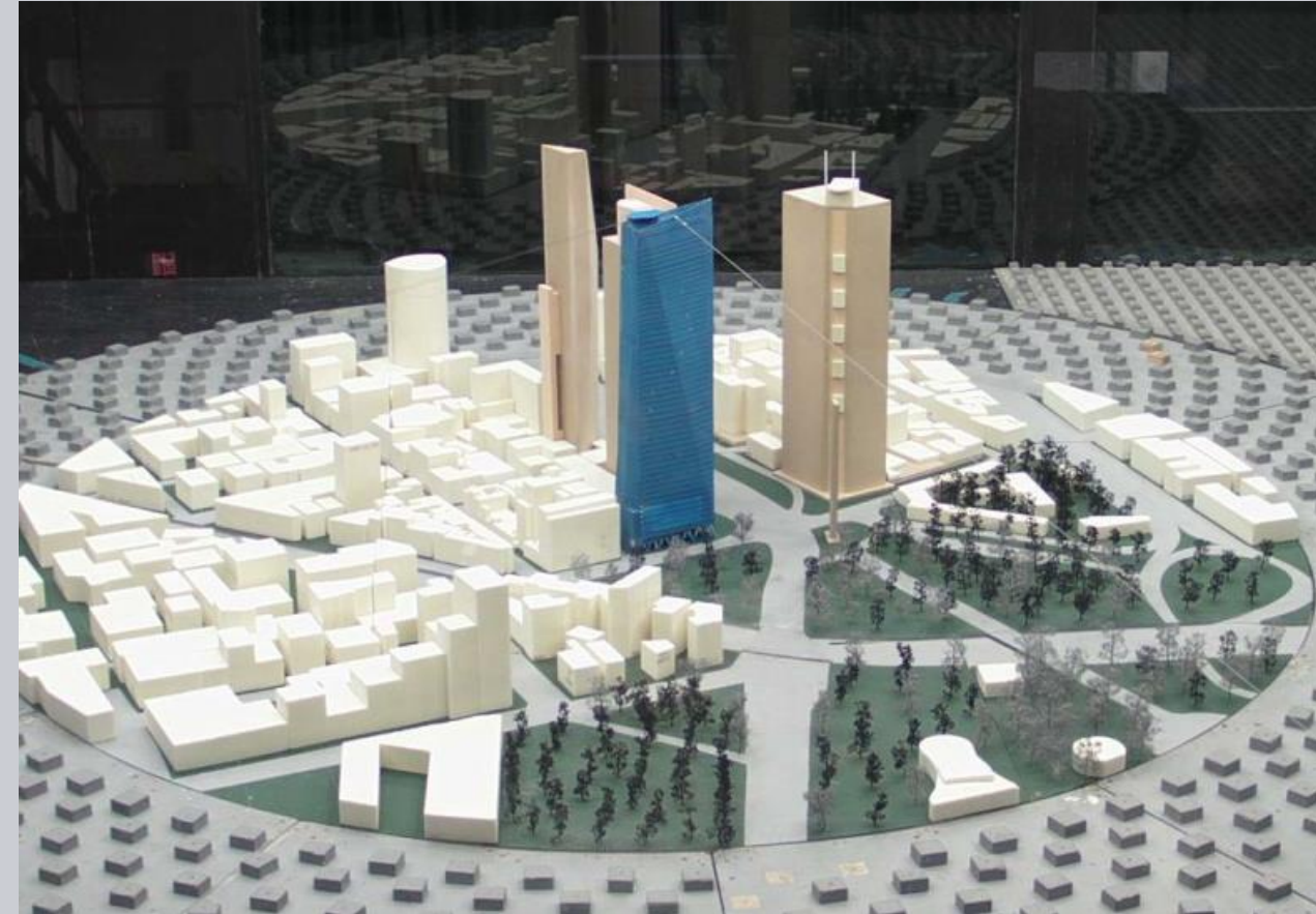
Influencia de Construcciones Cercanas en el Análisis del Túnel de Viento
