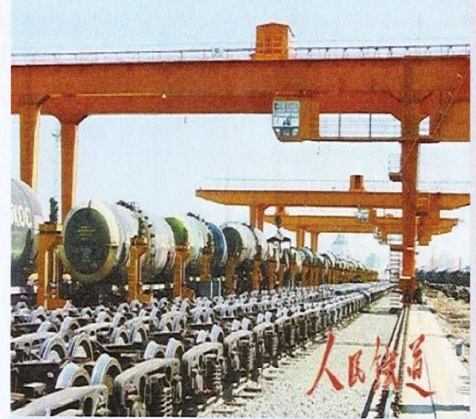
Cambio del bogie del ferrocarril China- Kazajstán
